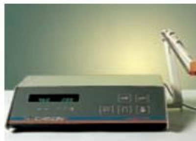
Figura 1. El pH se mide con un instrumento denominado pHmetro, que utiliza un electrodo muy sensible para medir el grado de acidez de una disolución.
